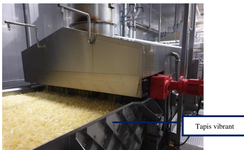
Illustration n° 27 : Sortie de friteuse (Source : photographie du site Ecofrost sur la commune de Peruwelz en Belgique)
