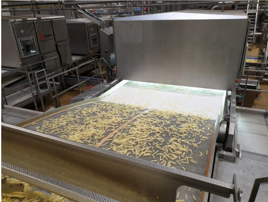
Illustration n° 23 : Entrée de l'installation de tri optique après découpe (Source : photographie du site Ecofrost sur la commune de Peruwelz en Belgique)
