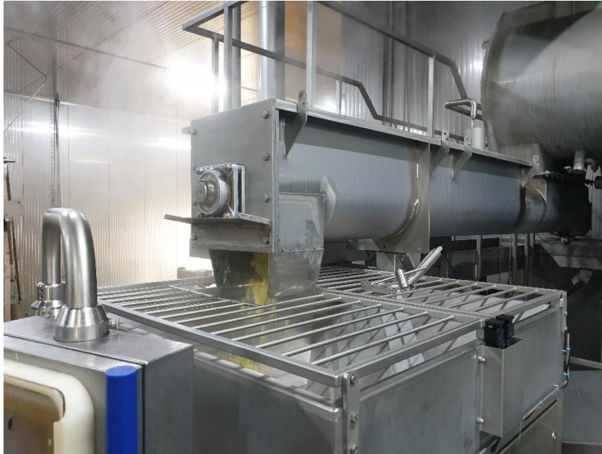
Illustration n° 37 : Mélangeur presseur à vis sans fin (Source : photographie du site Ecofrost sur la commune de Peruwelz en Belgique)
