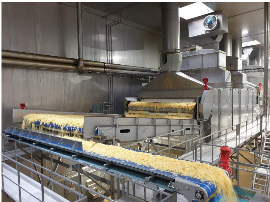
Illustration n° 25 : Frites en sortie de sécheur (Source : photographie du site Ecofrost sur la commune de Peruwelz en Belgique)
